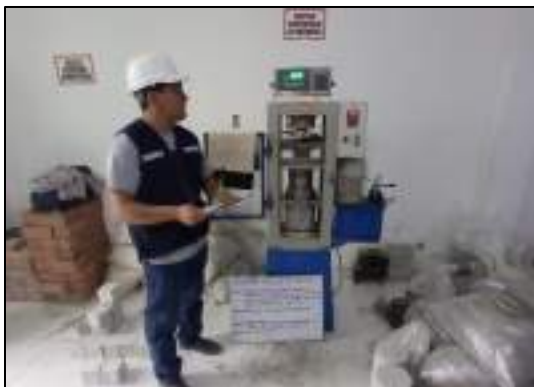
Rotura de cubos de mortero
