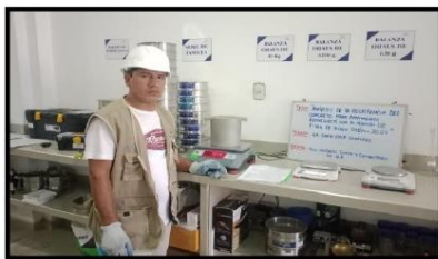
Imagen N° 09: Pesar el molde con el agregado fino y del agregado grueso para obtener el peso unitario suelto.
