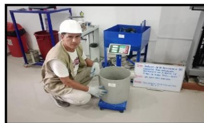
Imagen N° 10: Peso y volumen del molde. Se realiza el cuarteo de muestras
