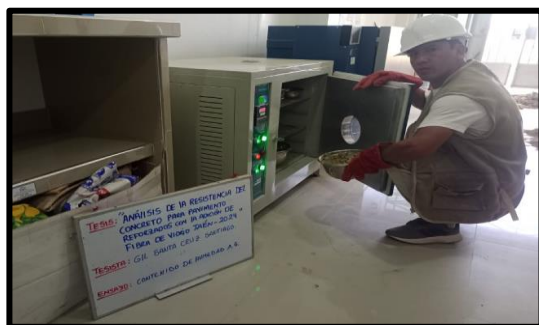
Imagen N° 02: Introducción al horno a 110 °C durante 24 horas.
