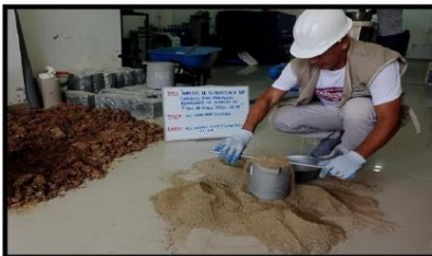
Imagen N° 09: Pesar el molde con el agregado fino y del agregado grueso para obtener el peso unitario suelto.
