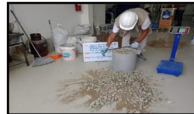
Imagen N° 09: Pesar el molde con el agregado fino y del agregado grueso para obtener el peso unitario suelto.
