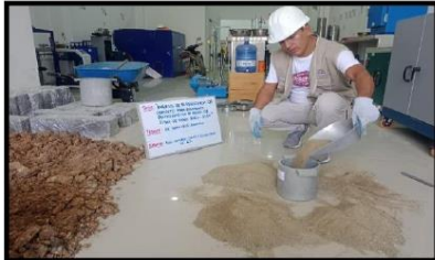
Imagen N° 08: Enrasado de la superficie del molde con la varilla, para ambas muestras.
