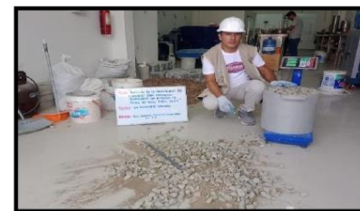
Imagen N° 09: Pesar el molde con el agregado fino y del agregado grueso para obtener el peso unitario suelto.
