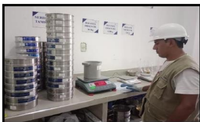
Imagen N° 10: Peso y volumen del molde. Se realiza el cuarteo de muestras
